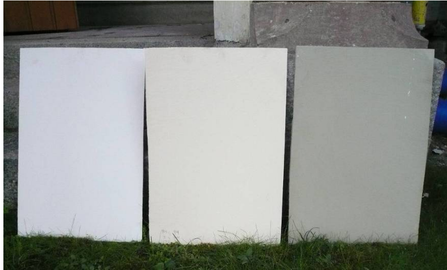
Framtagna kulörprover för utförande med kalklimfärg. Notera den svaga nyansskillnaden mellan de ljusa kulörerna. Det gråa provet är mycket ljusare och varmare än befintlig gråkulör.
